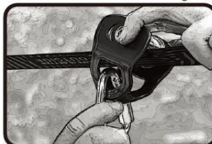
Karabiner an der Rolle befestigen.
