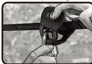
Fixez le mousqueton au galet.
